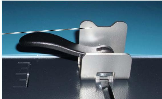
11. Kada tiskarske ploče pozicionirate centrirano, gurnite graničnike formata na tiskarske ploče.
