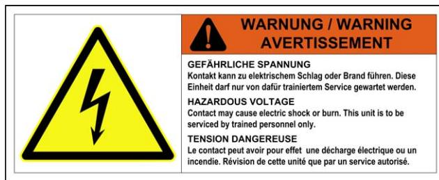
Oznaka upozorenja na opasan električni napon nalazi se na lijevoj i desnoj strani u unutrašnjosti uređaja DCL (vidi "[Položaji pločica na uređaju DCL](#)", stranica 54).
