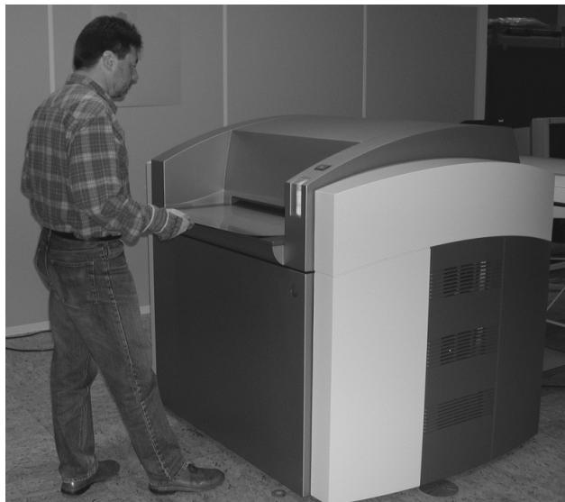
6. Gurnite tiskarsku ploču toliko u Suprasetter, da stražnji rub tiskarske ploče završava s oznakom ploče za ubacivanje. Stražnji rub tiskarske ploče mora biti u sredini i paralelan s oznakom ploče za ubacivanje.
