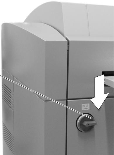
2. Pritisnite tipku za uključivanje/isključivanje uređaja Suprasetter koliko je moguće prema dolje i ponovno je pustite.
