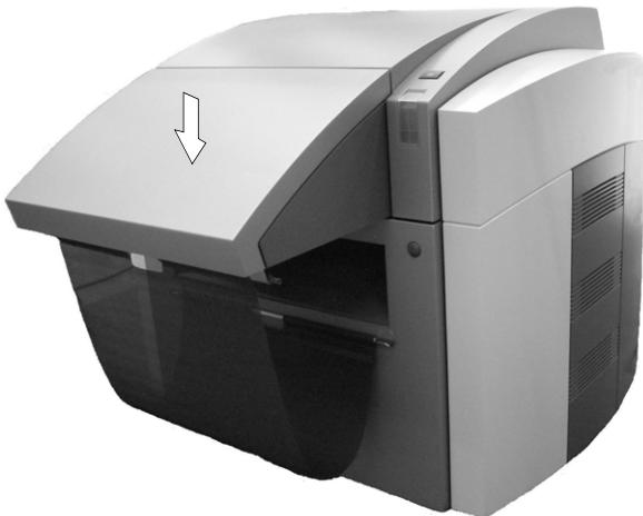
11. Na korisničkom sučelju uređaja Suprasetter, u registru „Unos > Čarobnjak za materijal“ kliknite na gumb „Zaključaj“. Poklopac uređaja Suprasetter je sada pod nadzorom.
