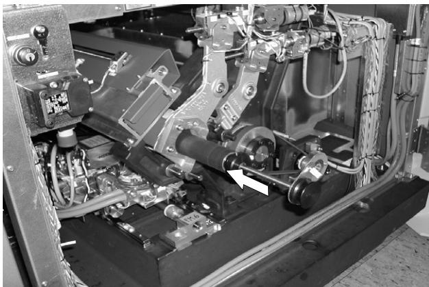
7. Pričvrstite ležaj valjka za čišćenje jednom četvrtinom okreta vijka.
