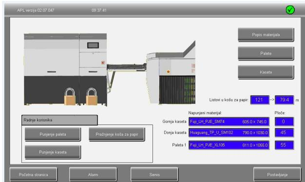
Stroj provodi referentno pokretanje. Stroj je spreman za rad kada se prikaže slika rukovanja i kada je u gornjem desnom dijelu vidljiva zelena točka.
