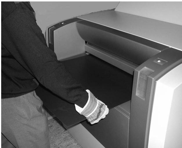
6. Ωθήστε την πλάκα εκτύπωσης στο Suprasetter τόσο ώστε η πίσω ακμή της πλάκας να τερματίσει στην κλίμακα που υπάρχει στην έδρα εισαγωγής.
