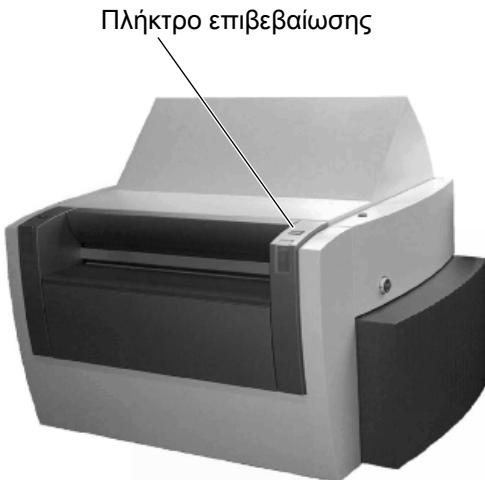
**i** **Υπόδειξη:** Το Suprasetter τραβάει την πλάκα εκτύπωσης προς τα μέσα και ελέγχει την κλίση. Εάν η πλάκα εκτύπωσης έχει τοποθετηθεί υπερβολικά λοξά, η πλάκα μεταφέρεται αμέσως πίσω στην έδρα εισαγωγής. Ακούγεται τρεις φορές ένα ηχητικό σήμα και η λυχνία στο πλήκτρο εισαγωγής αναβοσβήνει. Η διαδικασία φόρτωσης πρέπει να επαναληφθεί με την πλάκα εκτύπωσης ευθυγραμμισμένη.
